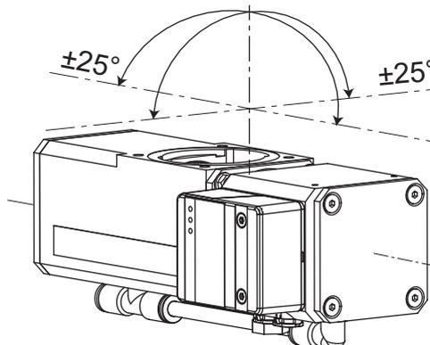
**Abb. 4: Empfohlene Ausrichtung des Vorvakuumanschlusses bei Verwendung ölgedichteter Vorpumpen**
