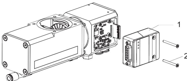
**Abb. 14: Demontage und Montage der Antriebselektronik TC 80**
