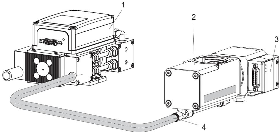
**Abb. 6: Beispiel für den Vorvakuumschluss an HiPace 10 Neo**
