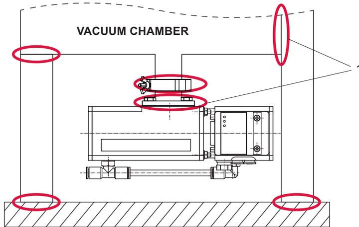
**Abb. 3: Beispiel: Sicherung gegen Verschieben und Kippen durch externe Erschütterungen**
