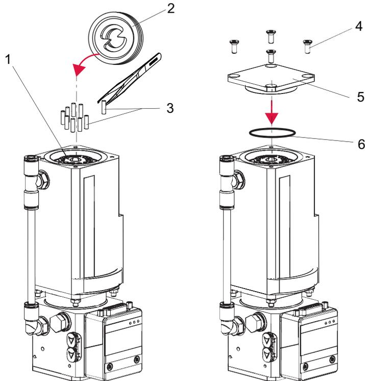
Abb. 11: Betriebsmittelspeicher montieren
