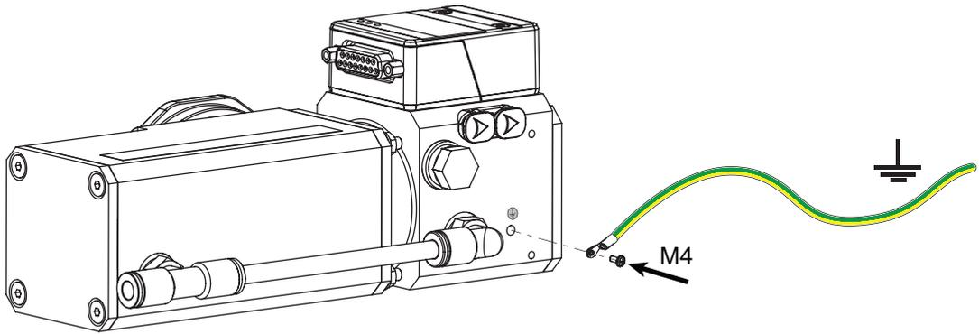
**Abb. 8: Beispiel: Anschluss des Erdungskabels**
