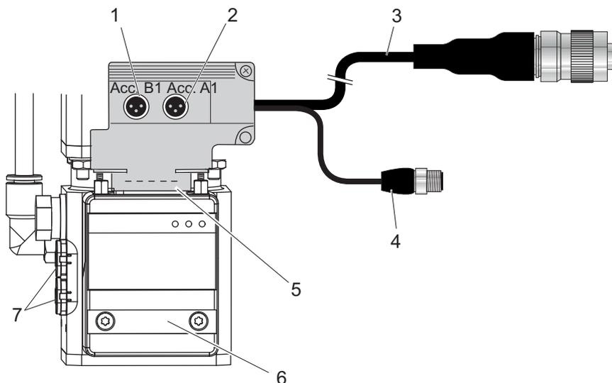
**Abb. 7: Zubehöranschluss über Verbindungskabel**
