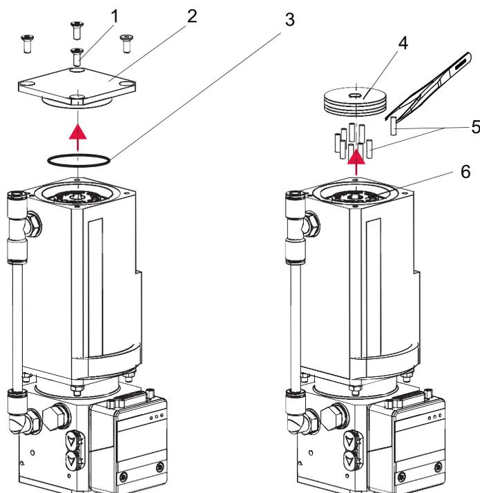
**Abb. 10: Betriebsmittelspeicher demontieren**
