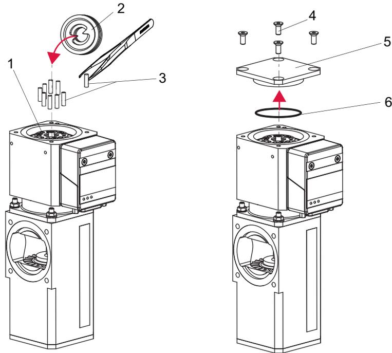
**Abb. 13: Betriebsmittelspeicher montieren**
