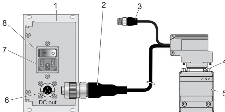
**Abb. 9: Antriebselektronik mit Netzteil verbinden**
