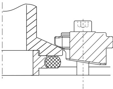
**Abb. 5:** Flanschverbindung für DN 40 auf DN 40 ISO-KF mit C-Klammer
