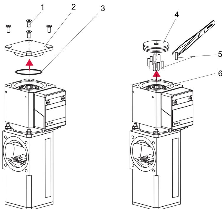
**Abb. 12: Betriebsmittelspeicher demontieren**
