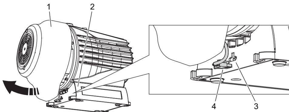
**Fig. 21: Removing fan plug**
